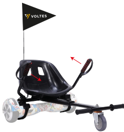
Naar links Handvat rechts naar beneden duwen, handvat links omhoog trekken.
